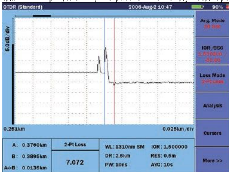
Рис. 3: Высокое разрешение MT9083 позволяет обнаружить объекты в линии, даже если они расположены очень близко.
