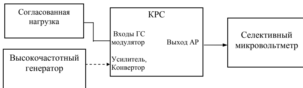
Рисунок 7.4 - Структурная схема для определения отношения радиосигнала изображения к шуму
