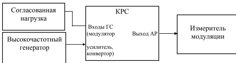
Рисунок 7.6 – Структурная схема для определения отношения сигнала изображения к фоновой помехе
