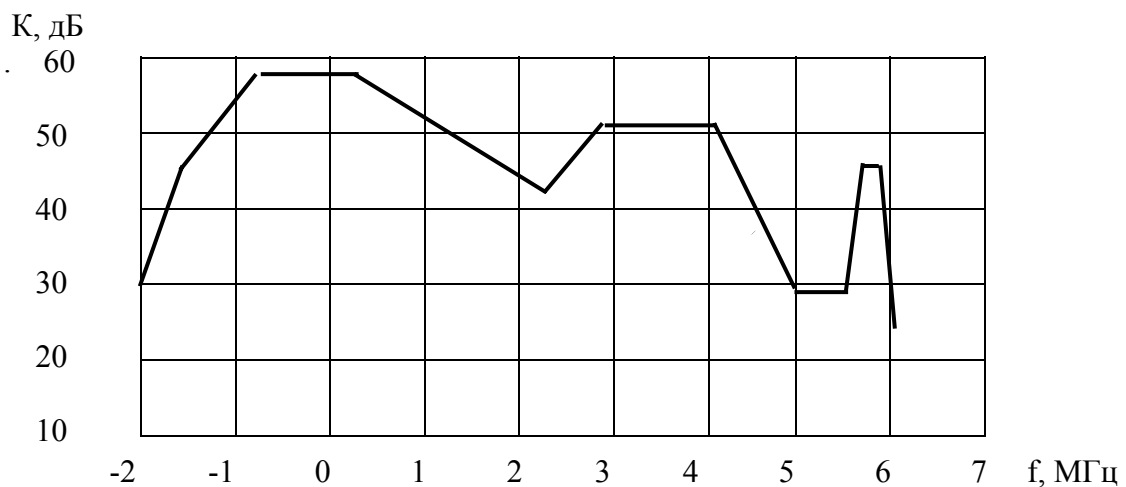
Рисунок 5.1 - Кривая защитных отношений для системы вещательного телевидения
