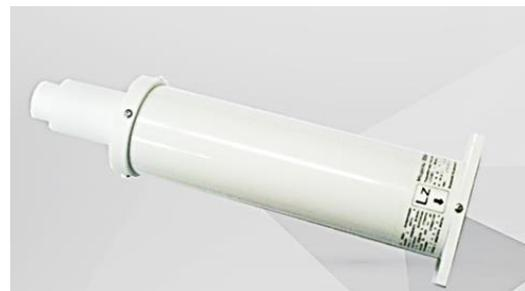
Облучатель поставляется в сборе. Если поляризация облучателя совпадает с требуемой, то закрепите облучатель на зеркале. Расстояние от крышки антенной головки до хомута держателя в начальном положении составляет 50 мм. Для подстройки сигнала перемещайте облучатель вдоль его оси. Изолируйте зазор между волноводом и фланцем герметиком идущим в комплекте.
